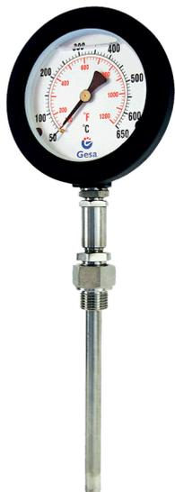
Thermomètres de dilatation de gaz fabriqué selon la norme EN 13190. Instrument fiable pour des conditions extrêmes de travail comme les vibrations de moteurs, l'humidité ou les milieux agressifs comme l'eau de mer. Spécialement conçus pour mesurer la température des gaz d'échappement des moteurs. Le boîtier du pyromètre est rempli avec huile de silicone pour amortir les vibrations.
